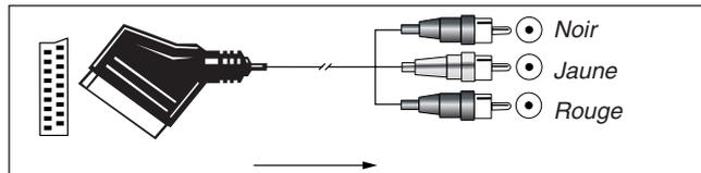
Figure 2 : adaptateur PÉRITEL/Cinch pour l'enregistrement et l'écoute ; sens du signal : PÉRITEL ↔ Cinch
