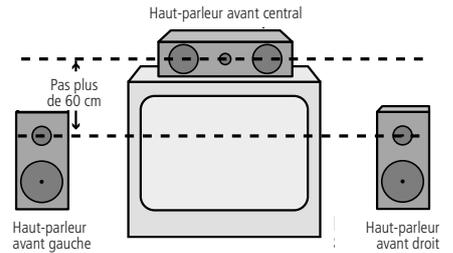
A) Installation des haut-parleurs du canal avant avec téléviseur à vision directe ou à projecteur derrière l'écran.
