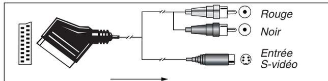
Figure 5 : adaptateur PÉRITEL/S-vidéo pour l'enregistrement et l'écoute ; sens du signal : PÉRITEL ↔ Cinch
