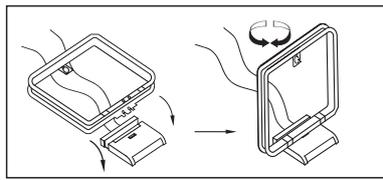
5. Branchez l'antenne FM fournie sur la prise **FM (75 Ohms) 7**. L'antenne FM peut être une antenne de toit, une antenne intérieure alimentée ou une antenne filaire ou encore un branchement d'un système par câble. Notez que si l'antenne ou le branchement utilise un câble à paires sous plomb de 500 Ohms, il faut que vous utilisiez l'adaptateur 500 Ohms – 75 Ohms pour le branchement.
